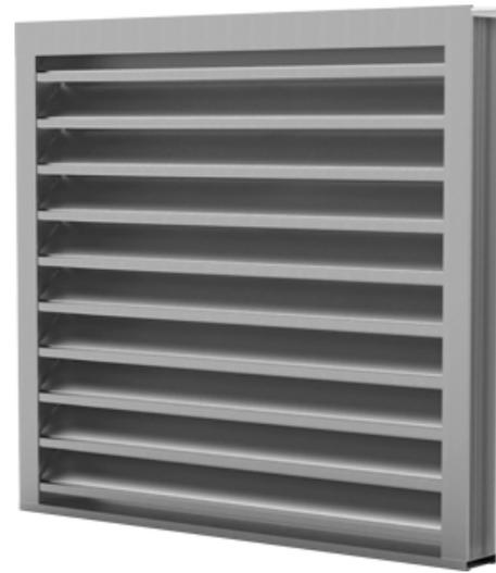
**CONSTRUCCION:** Marcos y aletas de perfiles de aluminio extruido de grueso calibre y de gran resistencia a la corrosión, aleación 6063-T5.
